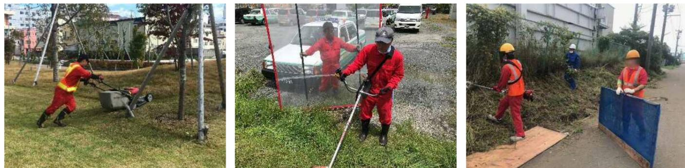
刈払い機の作業員資格取得後、早速お客様依頼の作業を開始しました。刈払い機の回転歯が、草を切るだけでなく石を飛ばし人や車に当てる事故を防ぐため防護ネットを移動させながら作業を行います。キレイに刈る技術と周辺の安全を確認する作業を同時に行うことで、作業注意の感覚を養えます。
