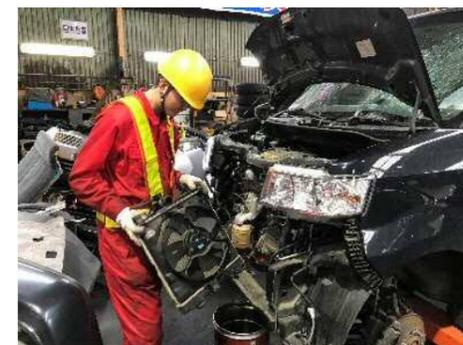
自動車リサイクル法に基づき、フロンガス回収処理・エアバック展開破壊処理・廃プラスチック及び鉄非鉄の適性処理、使用可能な自動車リユース部品の生産を行い国内、海外へと販路を拡大しています。自動車の機械構造はメーカー別に違いがあり分解する技術が必要です。利用者一人一人に対しエコブリッジ社員の技術指導とライブ職員によるフォローにて着実に技術を習得し、生産販売に大きく貢献しています。
